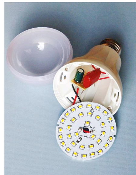
Figuur 1. Het inwendige van een goedkope LED-lamp: seriecondensator, diode, filterelco en ontladweerstand. De opdruk laat zien: 7 W in plaats van de opgegeven 10 W!
